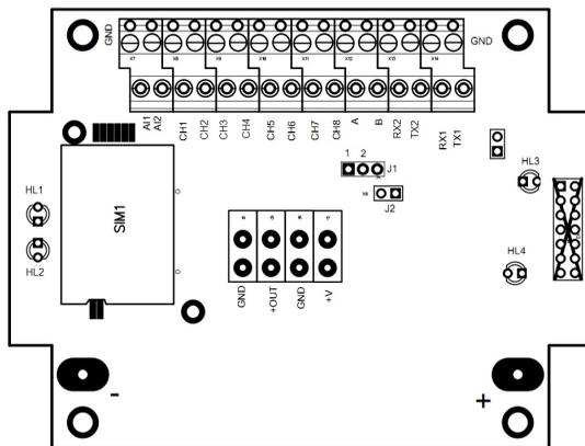
Подключение внешнего питания производится через нажимные клеммы, со снятой верхней крышкой в соответствии с рисунком:
