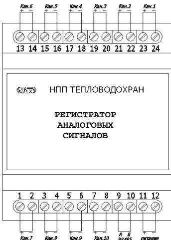
**Рис. 7.1** *Схема клемников*
